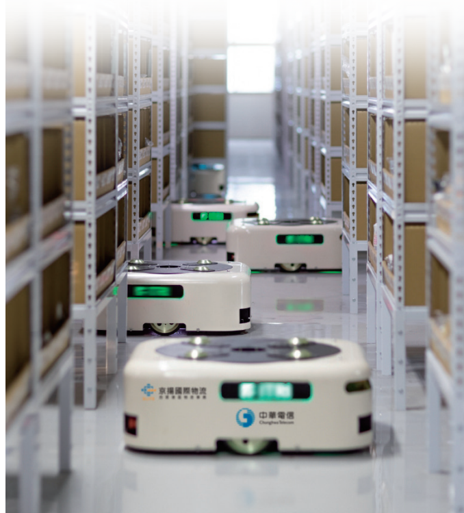
京揚導入中華電信 5G 企業專網，將自動導引車 (AGV) 透過中華電信提供專網訊號涵蓋範圍，實現高精度位置測量和自動化路線規劃。
